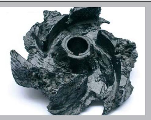
Коррозия разрушает детали насоса
